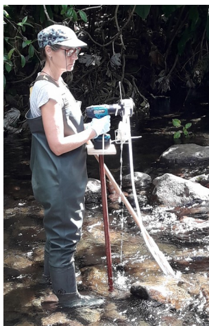
Figure 4 : Pompe de prélèvement
